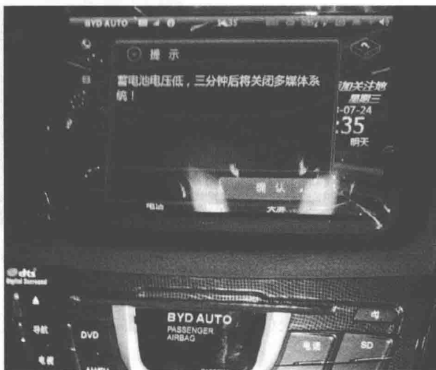
图 1-1-13 BMS 在系统电压低时关闭多媒体
