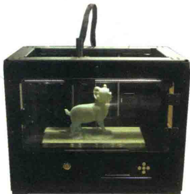
图1-3 桌面级FDM设备外观
