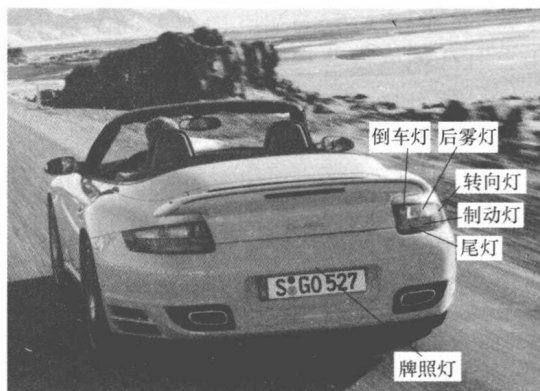
图 2-2 汽车后部电气设备
