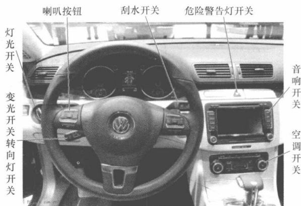
图 2-7 汽车前部的电气开关
