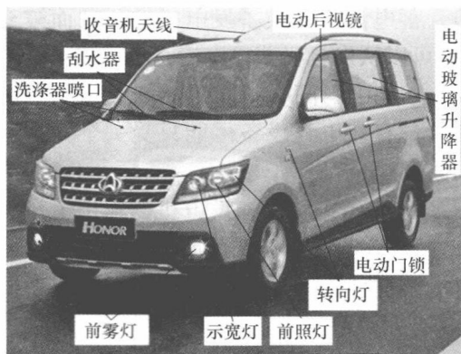
图 2-1 汽车前部电气设备
