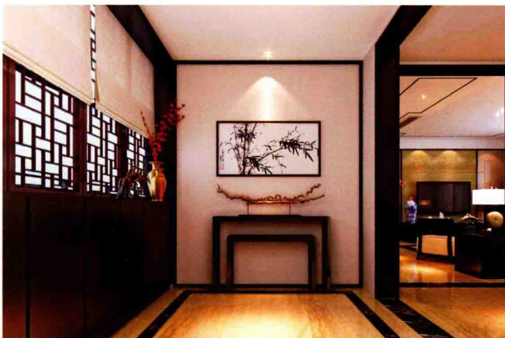
居中墙 [ 墙纸 + 木线条收口 ] 地面 [ 黑白根大理石波打线 ]
