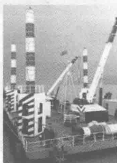
图5 桩腿长 36 m 自升式钻探平台
