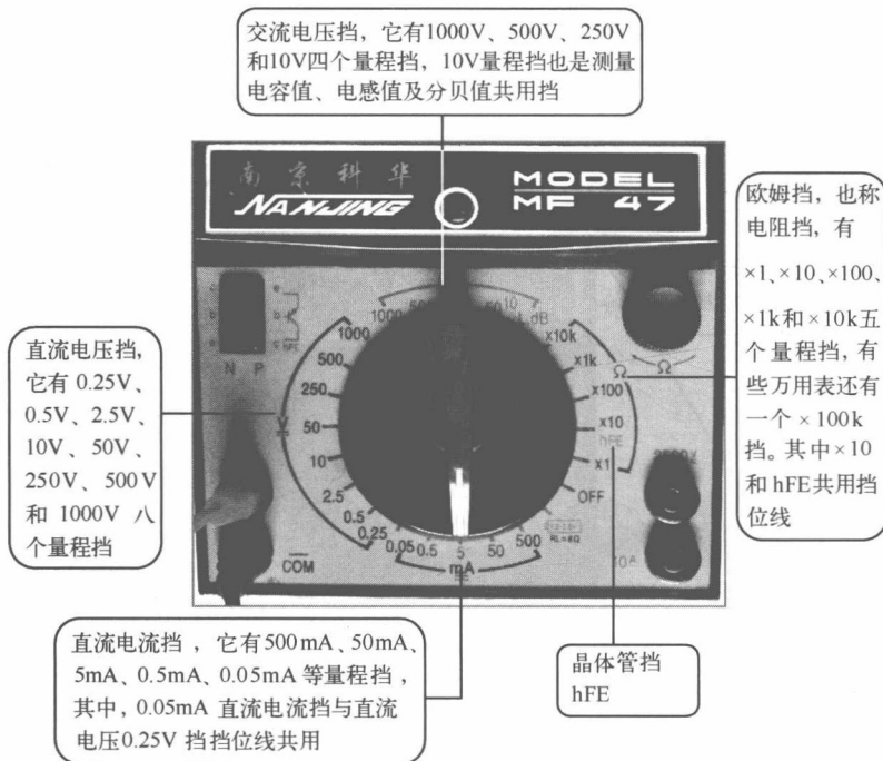
图 1-3 指针万用表的功能旋钮
