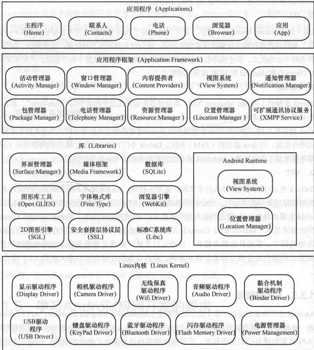
图 1-2 Android 的四层架构
