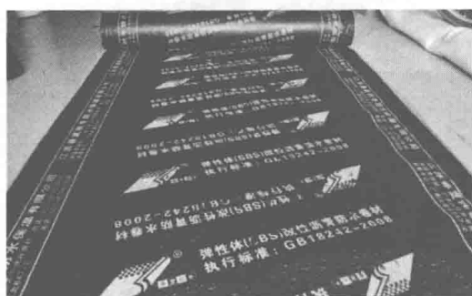
图 1-4 弹性体改性沥青防水卷材取样复试 注：同一类型、同一规格 10000m 2 为一检验批，不足 10000m 2 也按一批计。每批随机抽取 5 卷进行单位面积质量、面积、厚度及外观检查，检验合格后任取一卷，切除距外层卷头 2500mm 后，取 1m 长的卷材。
