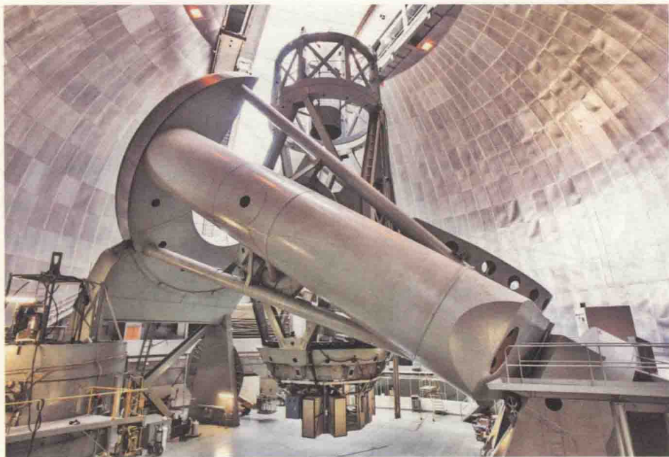
镜面5米的反射望远镜（直立的镜筒直径7米，高18米，镜面在镜筒底部）
