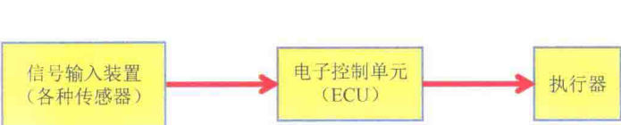
图 0-2 发动机电子控制系统的基本组成框图
