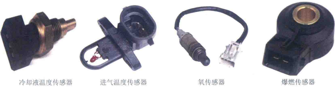
图 0-5 修正信号传感器实物
