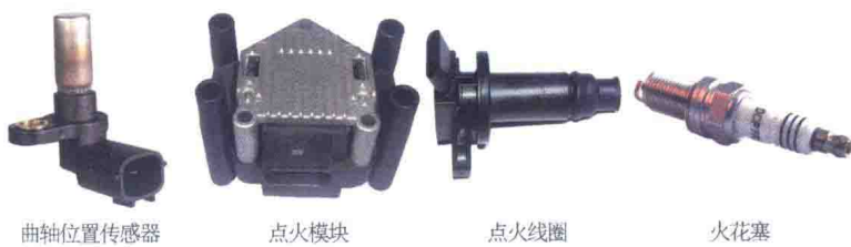
图 1-1-3 电子控制点火系统的主要部件
