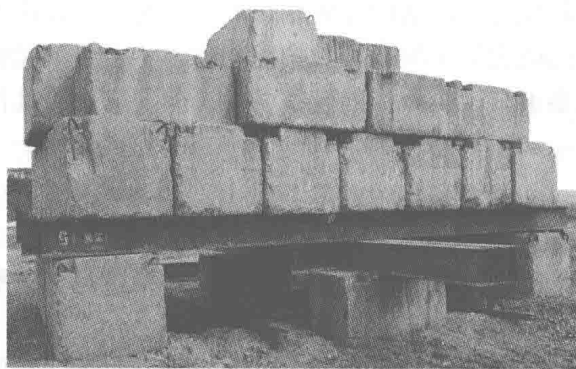
图 1-3 现场复合地基静载荷试验
