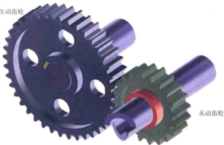
齿轮加速传动示意图
