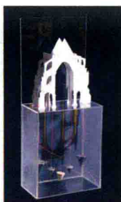
巴黎圣母院 | 法国·1163 建筑师/结构师：不明 飞扶壁力的传导路线(压缩流线)，通过应用“反吊原理”的模型中线的张力来表现。(58页)
