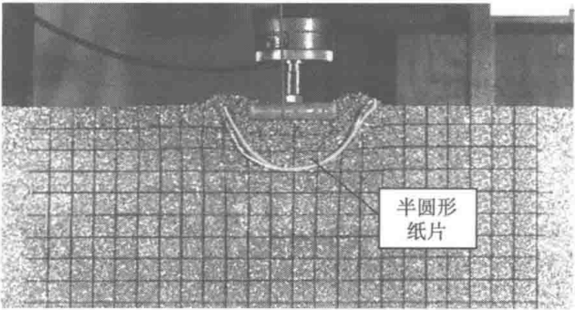
图 1.4 加筋纸半圆形布置情况下铝棒从基础两侧跑出
