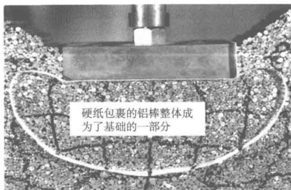
图 1.8 半圆形包裹铝棒受外荷载作用后的放大图
