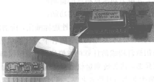
图 1.1-6 HP 公司生产的加速度信号测量传感器芯片
