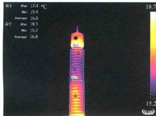
图 1-2-2 B相套管红外热成像图谱
