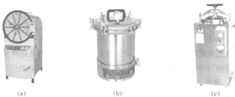
图 1-3 常见的高压灭菌锅类型 (a) 卧式; (b) 手提式; (c) 立式
