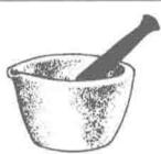
研钵  | 材料：<br>铁、瓷、玻璃、玛瑙等<br>规格：<br>以钵口径表示，如 12 cm、9 cm | 研磨固体物质时用           |        |
