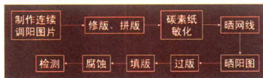
图1-14 凹版印刷原理示意图
