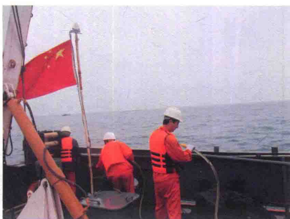
单道地震气枪震源释放（左）及水听器释放（右）
