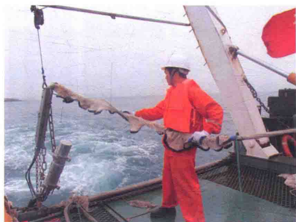
单道地震气枪震源释放（左）及水听器释放（右）
