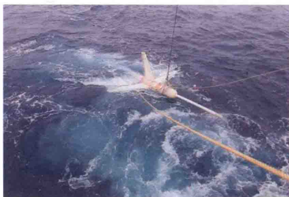
海洋 CSEM 系统拖曳式接收单元（左）及海底接收站（右）海试场景
