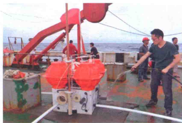
海洋 CSEM 系统拖曳式接收单元（左）及海底接收站（右）海试场景
