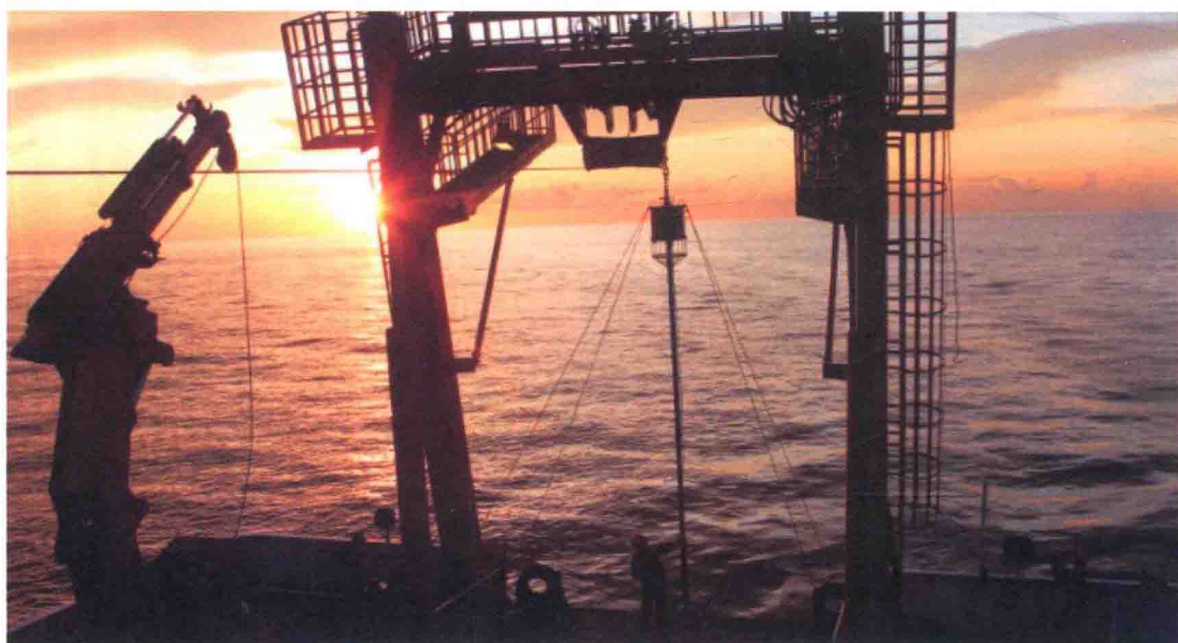
地热测量释放地热电子探针（国家海洋局第二海洋研究所提供）
