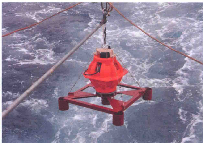
海洋 OBS 测量现场检查（上）及 OBS 释放（下）
