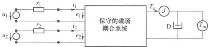
图 2-5 图 2-4 机电耦合系统的端点表示
