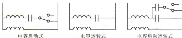
图 1-4 电容分相式电动机的电路原理
