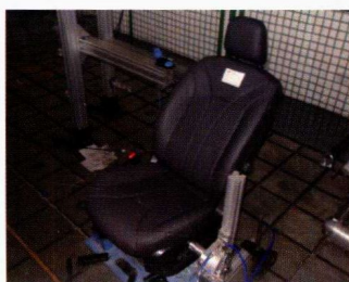
图 4.18 座椅调角器耐久试验
