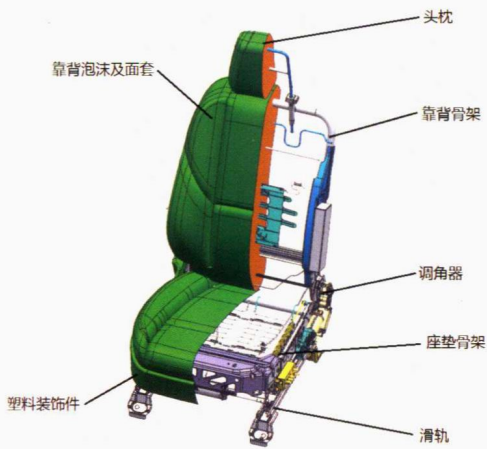
图 1.1 前排座椅构造及相关零部件
