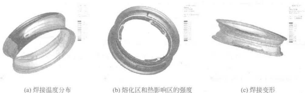
图 1-13 摩托车轮圈的焊接分析
