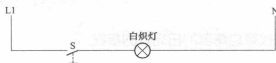
图 1 一只开关控制一盏灯的接线
