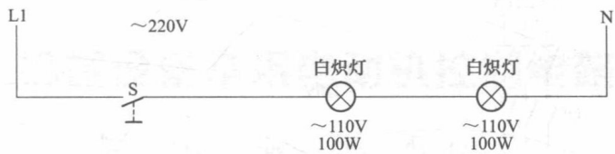
图 8 一只开关控制两盏相同规格 110V/100W 灯的接线
