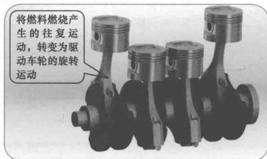
图 1-10 曲柄连杆机构
