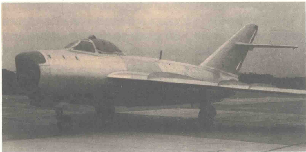
中国第一架测绘设计试制成功的高亚音速喷气式全天候飞机
