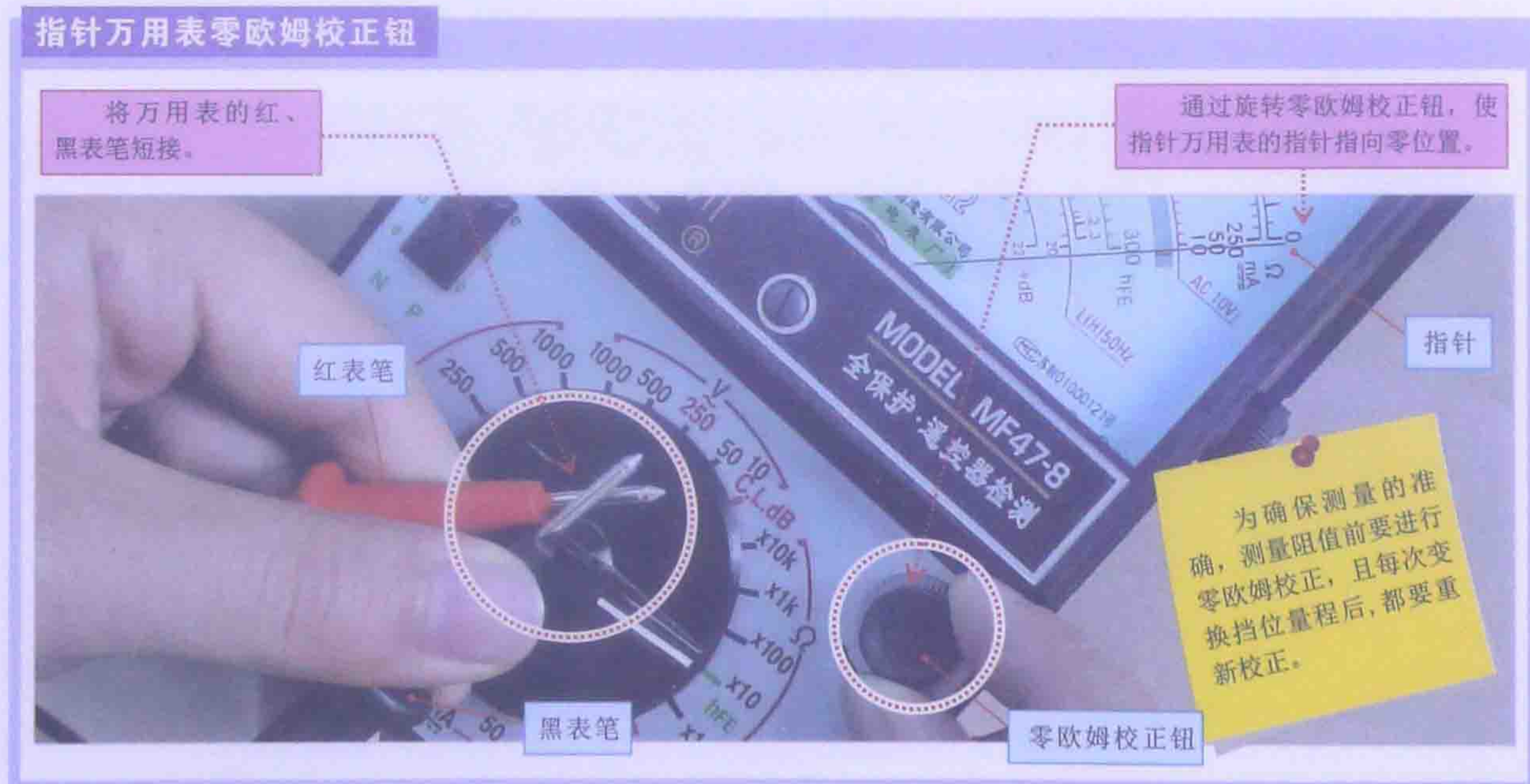
【图1-8 指针万用表零欧姆校正钮】
