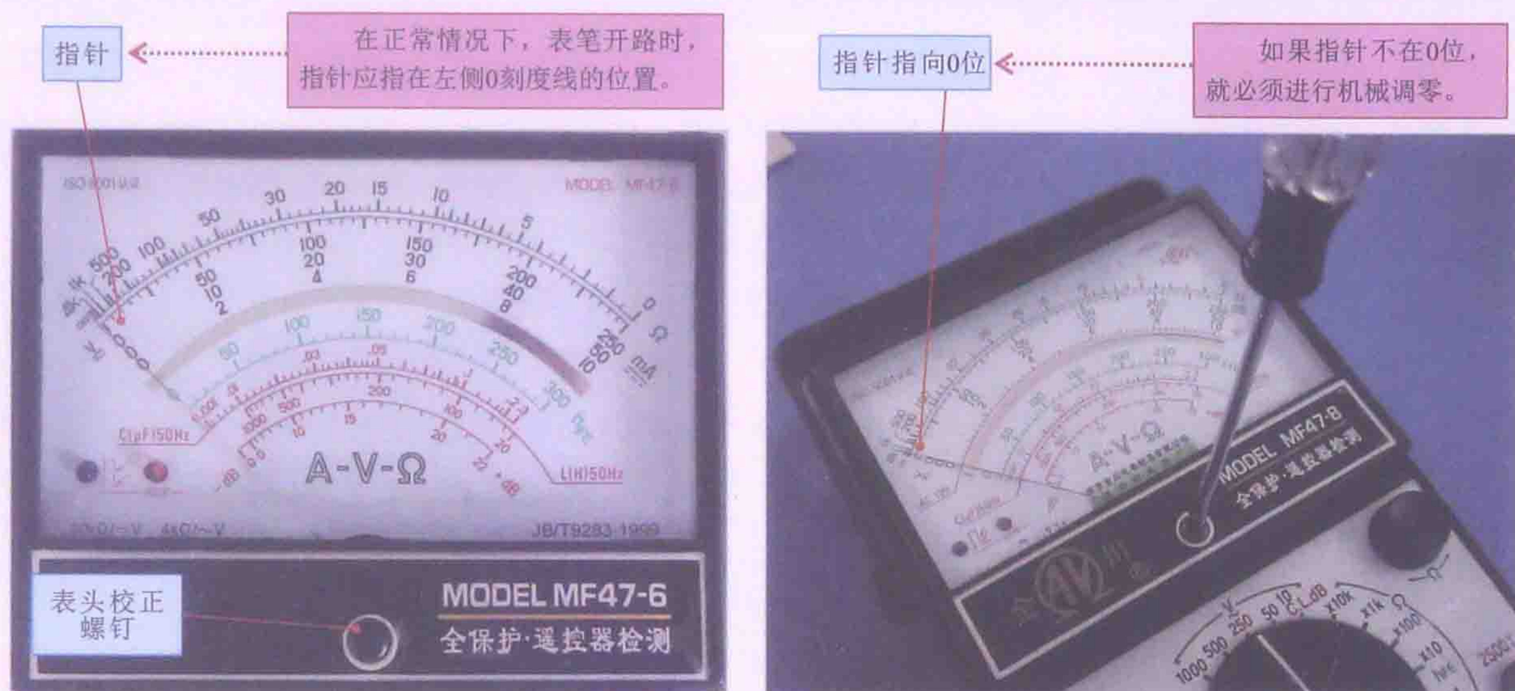
【图1-5 指针万用表的表头校正螺钉】
