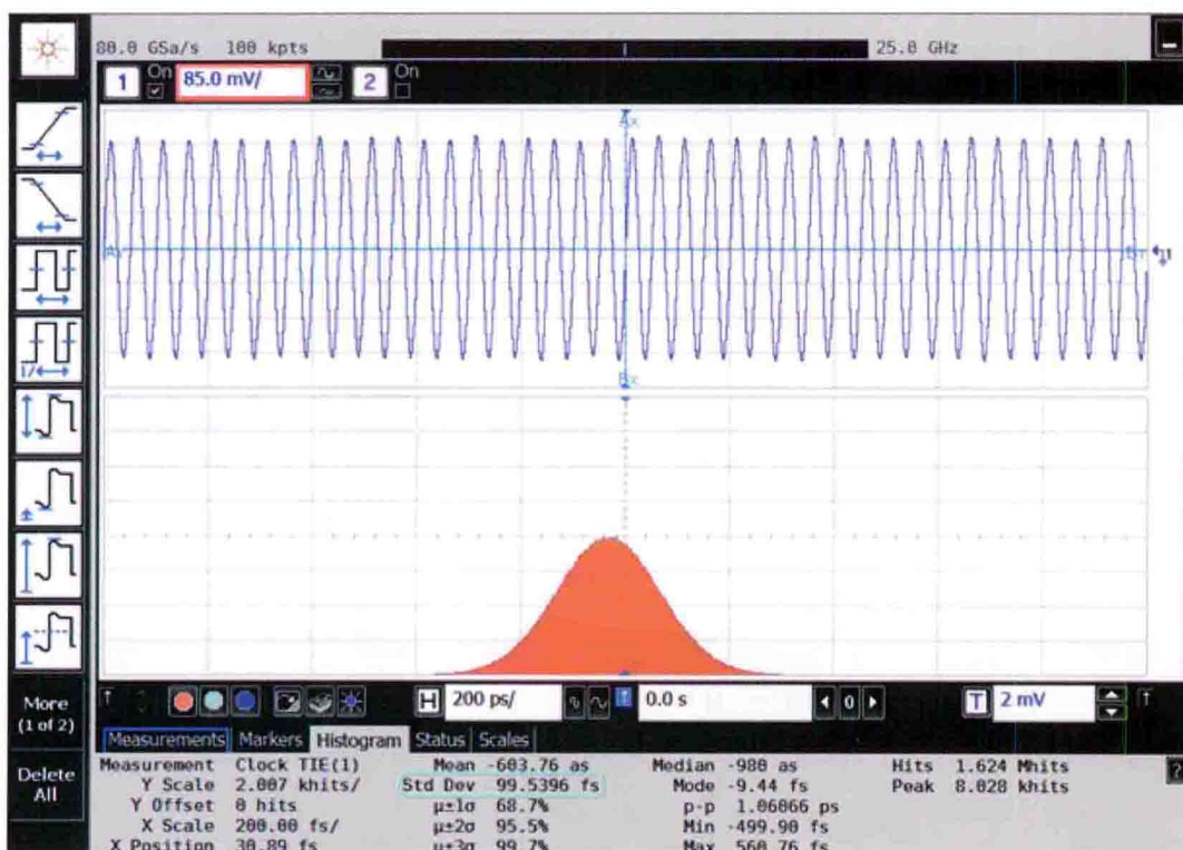
图 3.45 对 20GHz 正弦波的抖动测量结果
