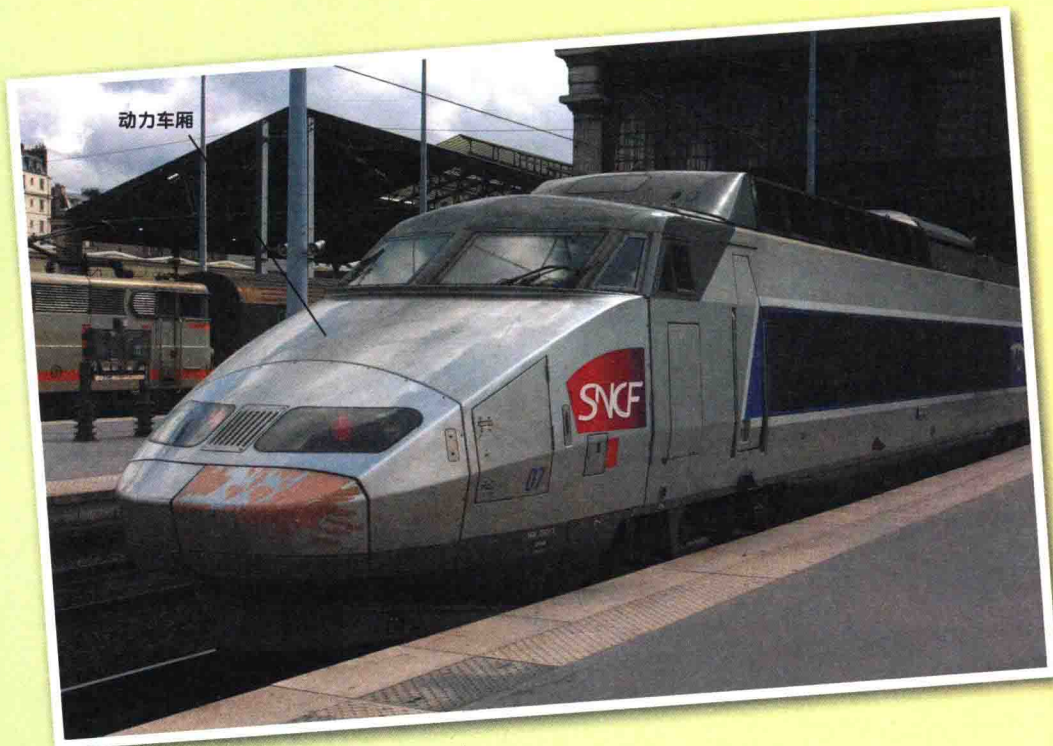
高速列车由布置在动力车厢内的电动机驱动。
