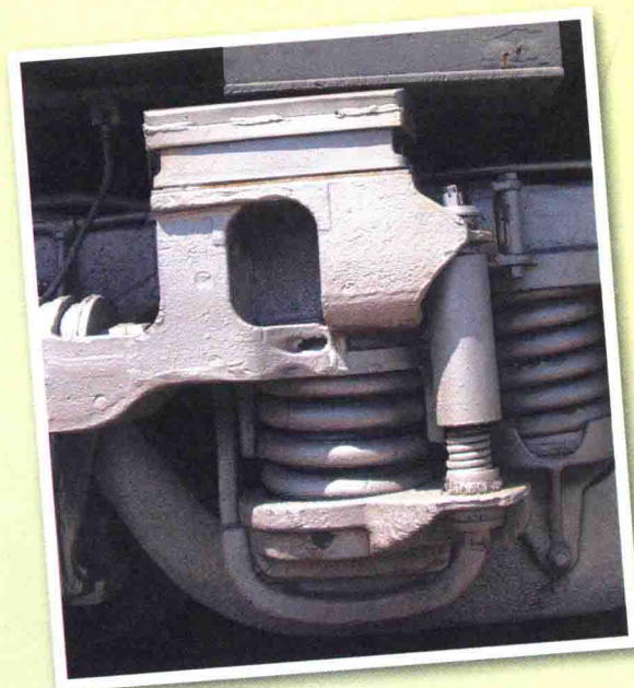
巨型弹簧吸收来自轨道的振动。
