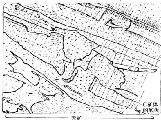
图11 中部盆地西侧，Mufulira 1400英尺中段。位于C矿体底部泥岩中的干裂构造，原来为藻席。含铜2~6%的矿石由斜线表示。分析品位的界线截然地切过两个大的灰色的具有鱼尾状末端的泥岩板片的底部，并且在左上方挤进中部剖面。这都表明干裂构造的存在。宽的干裂缝中的粗砂（粗大的黑点者）有轻微矿化，但向不规则的薄片的右方向下直到砂质充填物的中部，砂质物中均富含斑铜矿。右上方的泥岩层有较少的泥裂现象，指明出露水面少了。其中富含斑铜矿，而且在紧邻的砂质部分内甚至有更富的斑铜矿。矿体下面的浅黄色泥岩广泛分布有泥裂构造，它是无矿的。这证明矿化不是来源于下面的层位中。据照片描绘
