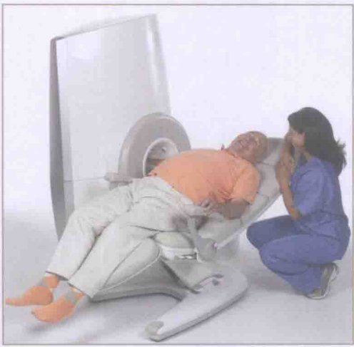
图1-2 ONI医学系统公司的MSK肢体磁共振机是唯一的一种高磁场强肢体磁共振机。它的信噪比与高磁场强全身磁共振机基本相同，体积较小，但不能对髌和肩进行扫描（承蒙得到ONI医学系统公司，Wilmington, MA的同意）
