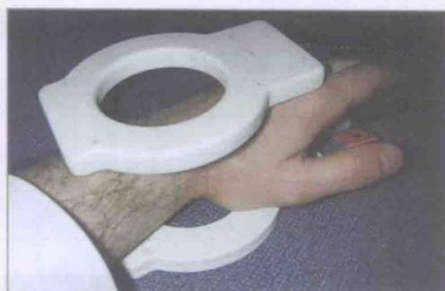
图1-4 环形双重线圈用于扫描腕关节时增强信号
