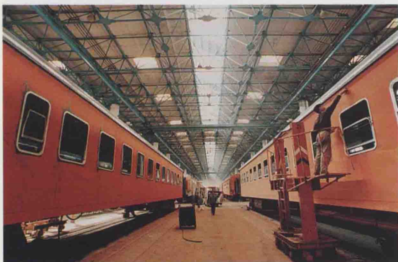
新厂客车组装车间
