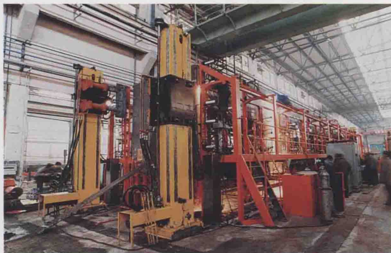
工厂研制的客车外墙板组装电热胀拉装置
