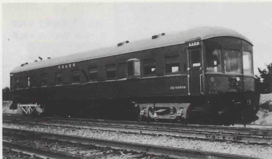
1953年设计制造第一 代机械传导轨道检查车
