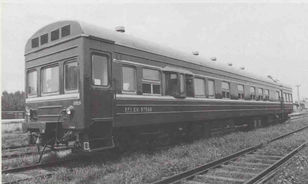
1969 年设计制造的电气 传导轨道检查车
