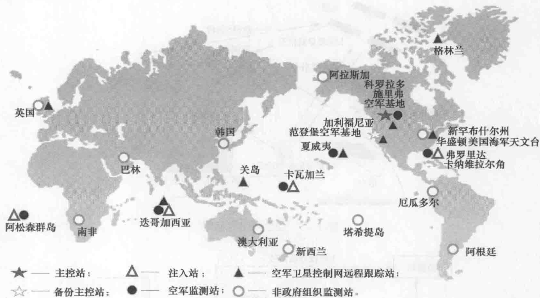
图 1-4 GPS 系统的地面监控部分
