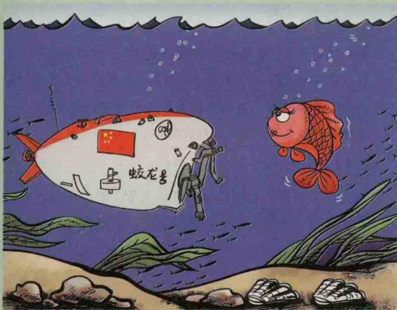
“蛟龙号”是我国首台自主设计、自主集成研制的作业型深海载人潜水器，设计最大下潜深度7000米级，也是目前世界上下潜能力最深的作业型载人潜水器。
