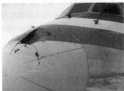
图 1-5 鸟体对机头雷达罩的撞击
