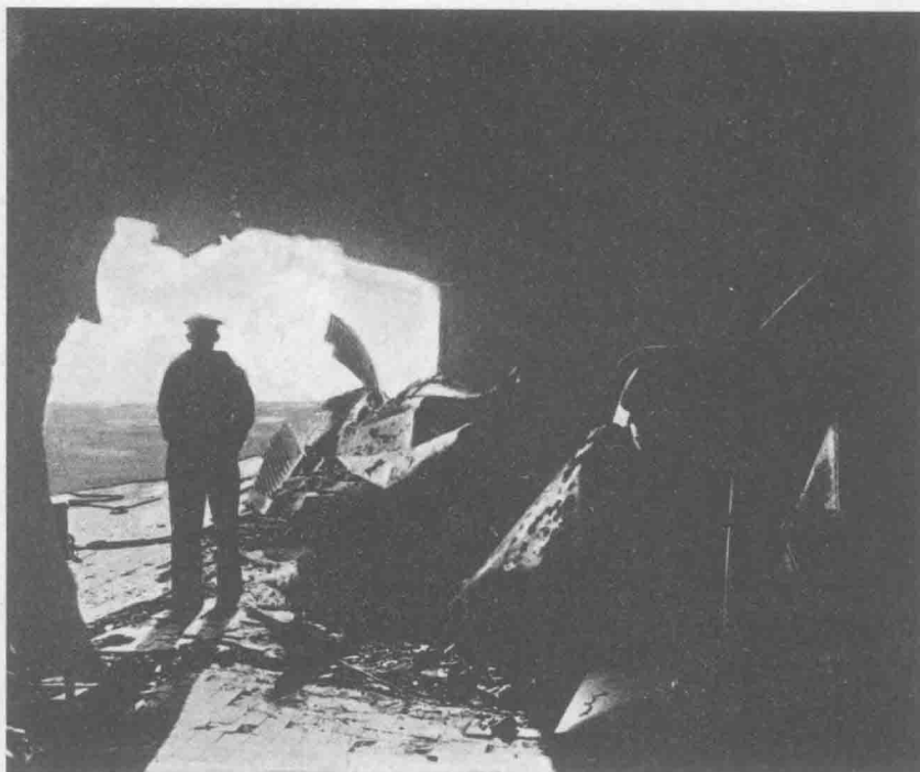
←在日德兰，一枚英军炮弹将“德福林格”号舰桥下方的装甲打出一个大洞。这艘战斗巡洋舰中了21弹，身体重创却依然浮在水面上。
