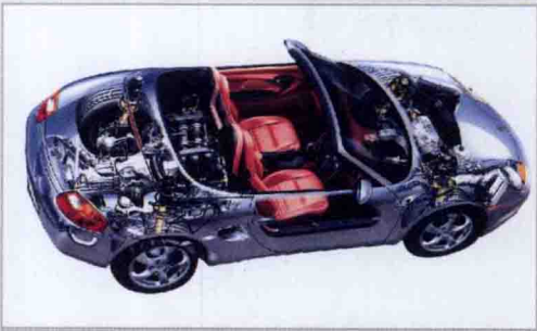
图4 发动机中置后轮驱动
