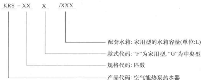
图 1-8 空气能热泵热水器 (同益型) 的型号含义
