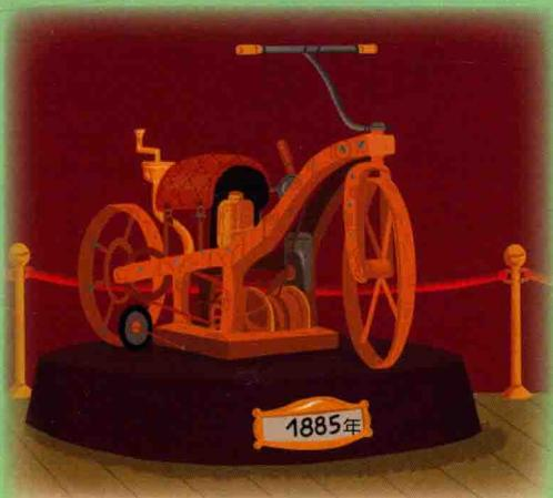
第一辆摩托车是木制的。它的后面有两个小轮，防止车子跌倒。车座很像马鞍。
