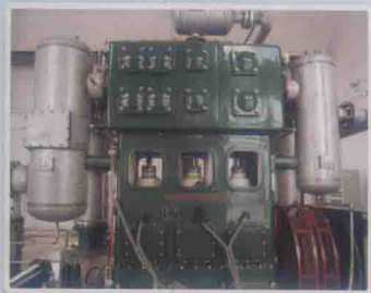
2000~2400m³/h 系列氧气压缩机 200~2400m³/h Series Oxygen Compressor
