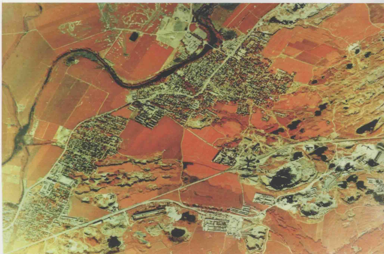
(上图) 唐山地震时(1976年7月28日), 滦南县北姜家泡的砂土液化——喷水冒砂和地裂缝现象(彩色红外航空影像)
