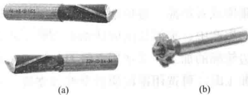
图 1-14 键槽铣刀 (a) 直柄键槽铣刀；(b) 半圆键槽铣刀
