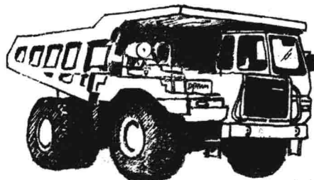
图 1-8 DP655 型载质量 50t 矿用汽车
