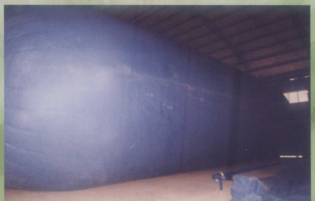
沈阳部队某空军基地正在使用我厂生产的1500m³氧气贮气囊
