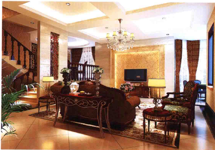
顶面：石膏板装饰梁刷白 电视墙：米黄大理石斜铺 + 洞石
