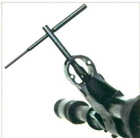
用准星扳手调节准星高低
