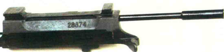
活塞杆推动枪机框前端面，使其后坐
