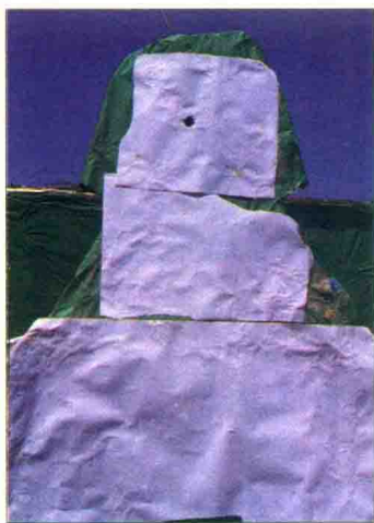
英国国际精密仪器公司的 AW50FT 12.7mm 非自动狙击步枪在 1070m 处击中 人形靶 1 发 (共射 3 发弹)
