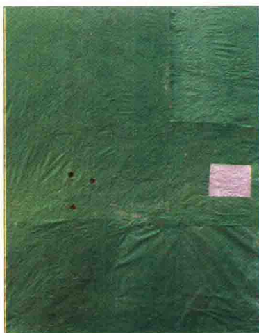
英国兰奇-蒙斯塔 12.7mm 狙击步枪在 900m 射距上打出了 R100=3.2cm 的好成绩
