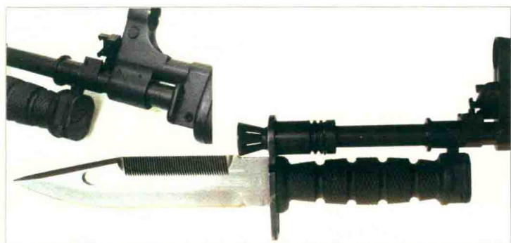
刺刀座的 T 形凸起被刀柄座上的左、右卡笋卡住，刺刀环套入枪口装置的气体膨胀腔上
