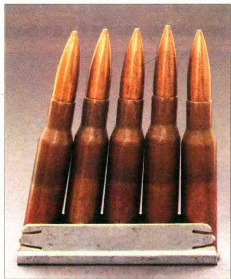
7.62x54mmR普通弹，这也是85式狙击步枪用弹。缺乏专用高精度枪弹已经成为了国产狙击步枪进一步提高水准的瓶颈
