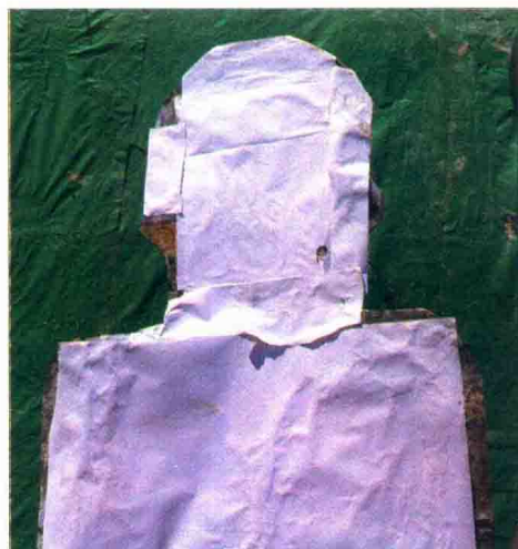
国产 M99 12.7mm 狙击步枪在 1070m 处击中 人形靶 1 发,另有 1 发子弹超出人形靶头顶 6cm (共射 3 发弹)
