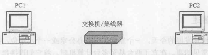
图 1-2 采用平行线通过交换机(或集线器)连接两机
