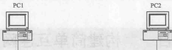
图 1-1 采用交叉双绞线连接两机的网卡
