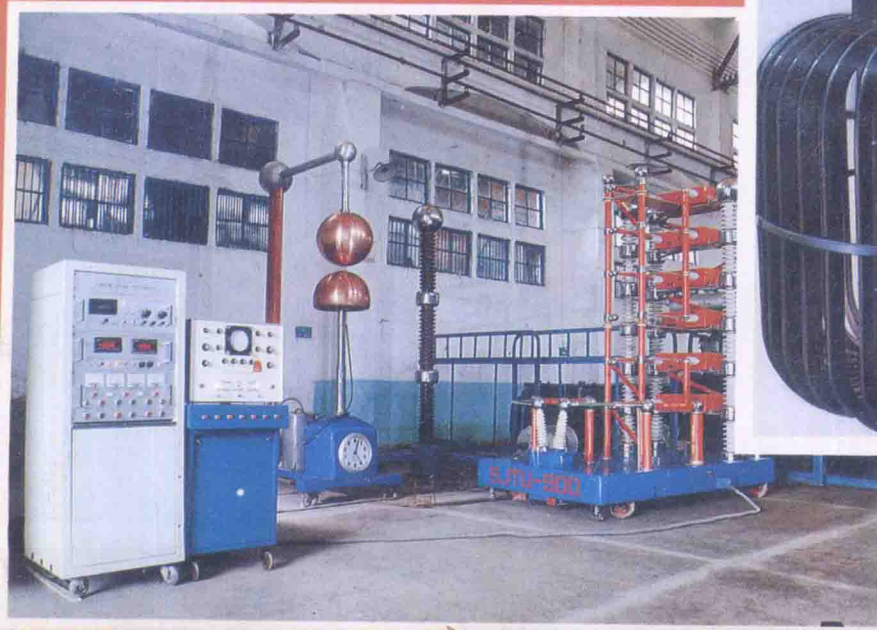
变压器检测试验设备——冲击电压发生器
