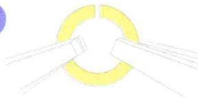
将单圈接口处朝上，然后用尖嘴钳夹住单圈两侧。
